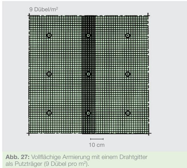
**Abb. 27:** Vollflächige Armierung mit einem Drahtgitter als Putzträger (9 Dübel pro m<sup>2</sup>).
